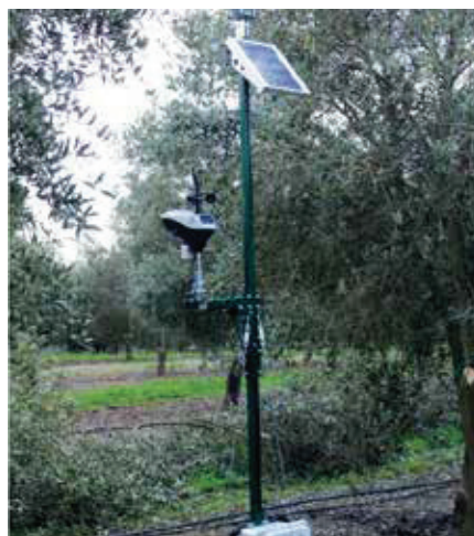
FOTO 3 Estação Telemétrica (Beja)
